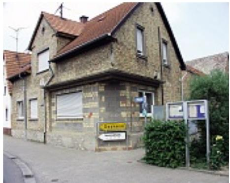
**Zerstörung der Fassadenansicht durch Einbau liegender Fensterformate und Materialwechsel im Erdgeschoss**
