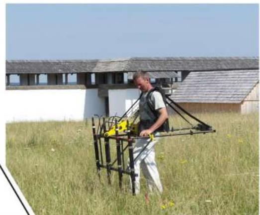
Vier-Kanal-Gradiometer FEREX bei der Messung
